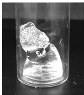
Abbildung 4. Probe eines kubischen Gels. Das Gel in der kubischen Phase ist ein klares, viskoses, geleeartiges Material, das temperaturstabil und hoch biokompatibel ist. [9]
